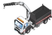
Montée derrière la cabine
